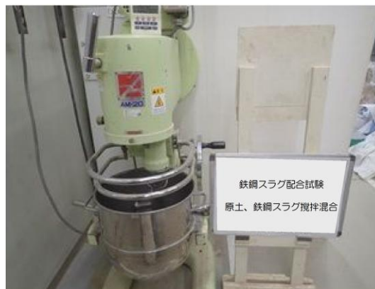
写真1 原土と鉄鋼スラグの攪拌状況
