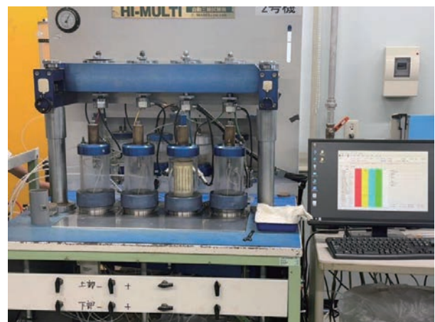
三軸圧縮試験の供試体飽和状況
