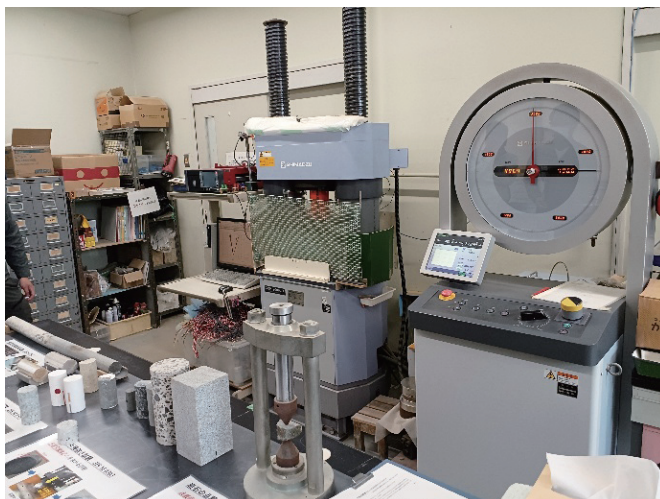
岩石の圧縮強さ試験機（左）と実際に圧縮した岩供試体（右）
