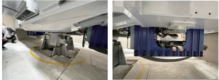
直径5mの回転翼と模型土槽
