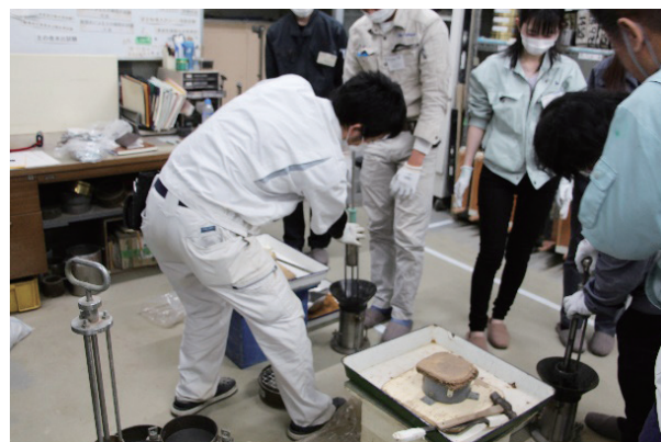
締固め試験体験の様子
