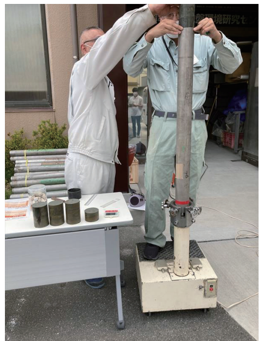
試料の抜き出し（※）
