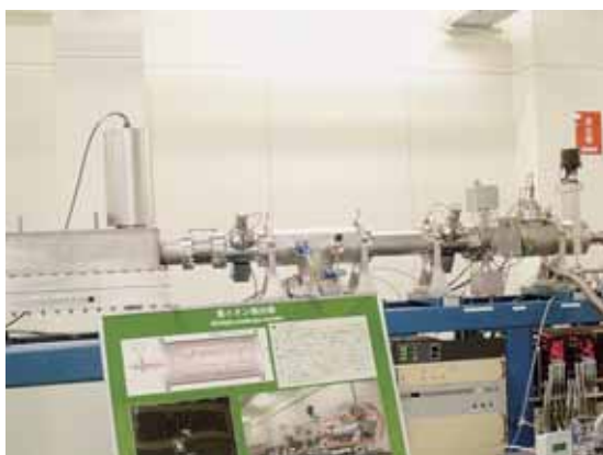
図3 ペレトロン年代測定装置
