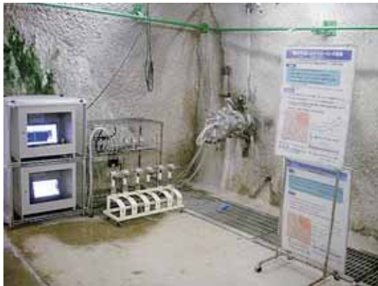
坑道内の地下水観測装置
