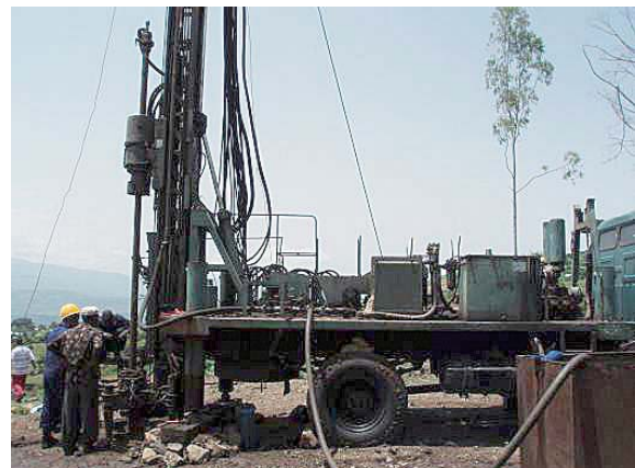
写真-2. エチオピアで使用しているボーリングマシン：デカ過ぎて、かなりの場所の制約と整地が必要
