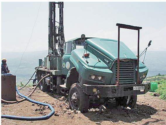
写真-2. エチオピアで使用しているボーリングマシン：デカ過ぎて、かなりの場所の制約と整地が必要
