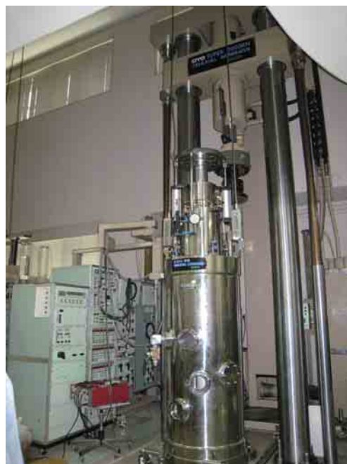
写真2 大型三軸圧縮試験機
