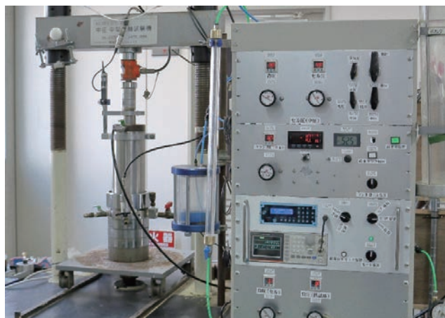
圧力制御系の改良を施した中圧三軸試験機
