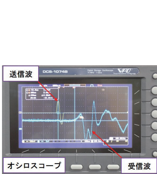
写真-2 オシロスコープからの波形測定 (例)
