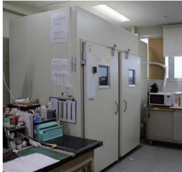
写真－ 1 恒温恒湿室外観
