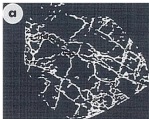
写真1 弱風化花崗岩の土粒子の画像処理写真
