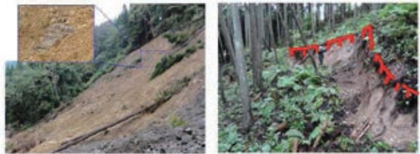
A-1ブロック下方の状況。露岩している。 B-1ブロック内の滑落崖
