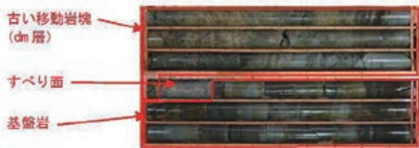
写真-3 コア状況 (すべり面付近)
