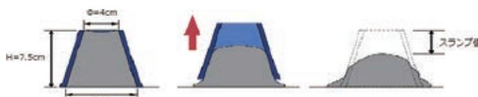
図-1 小型スランプ試験の概要
